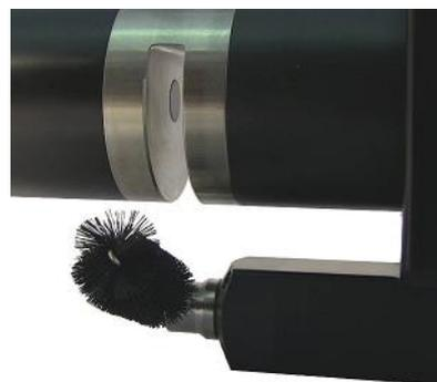
ハイドロ・ワイパーは、SUNA V2 硝酸塩センサーと完全に統合された外部防汚システムです。ハイドロ・ワイパーは、非常に活発な生物付着環境でも SUNA V2 のサンプリング・ウィンドウを数ヶ月間クリーンに保ち、手作業による掃除のためにサイトを訪れる高い費用やデータの損失を防ぎます。
