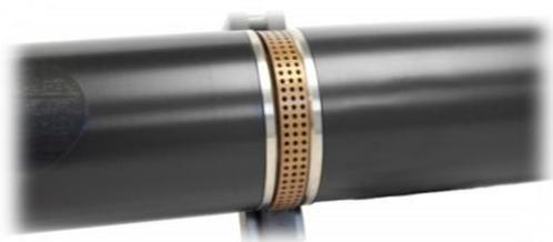
SUNA の防汚ガードは、サンプリング・チャンバーの中へ嵌めこむプラスチック製のアーマチャに取り付けられた穴のあいた銅製の半円形の部品です。防汚ガードは、銅イオンの放出を介してエリア内の生物の増殖を防ぐ受動的な汚れ防止です。防汚ガードは、係留用途のために観測時間を増やし、運用コストを削減して高品質なデータを集めるための信頼できる手頃なアプローチを提供します。
