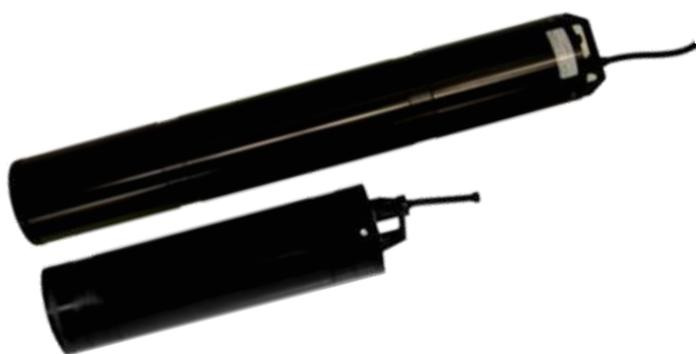
信頼性が高く使いやすい Satlantic のアルカリ・バッテリー・パック(102Ah と 51Ah の容量)が利用可能です。内部のバッテリー区画は、ユーザーが簡単に既製の単一電池と交換できるように設計されています。バッテリー・パックはアルマイト(陽極酸化アルミニウム)圧力ケース、単一電池区画、そして取り外し可能なエンドキャップで構成されています。
